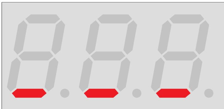
Если ток выдаваемый датчиком больше 20 мА на индикаторе соответствующего канала индицируется «----» красного цвета:
